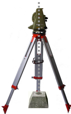
Figura 6.35 - Eixo principal do equipamento passando pelo ponto.
