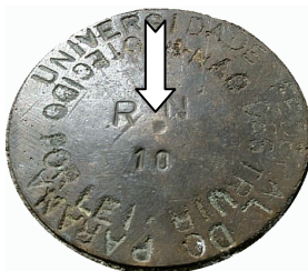
Figura 6.28 - Chapa metálica com a indicação do ponto topográfico.
