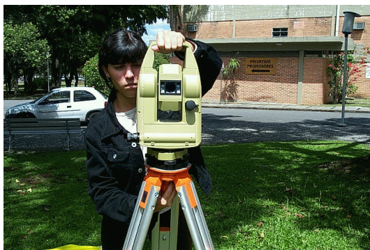
Figura 6.34 - Fixando o equipamento ao tripé.
