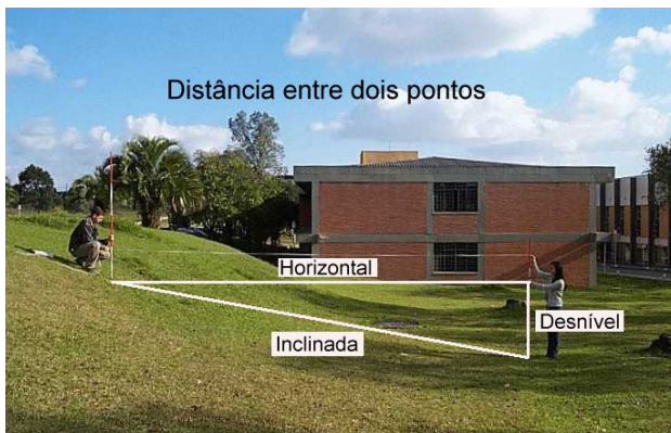
Figura 5.6 - Exemplo de medição direta de distância com trena.
