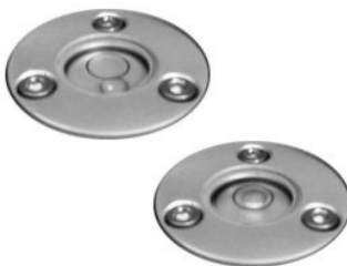
Figura 6.39 - Calagem da bolha do nível esférico.
