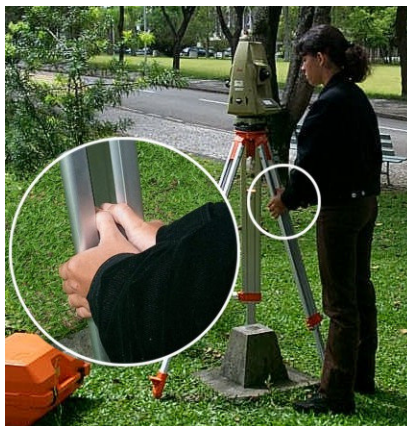
Figura 6.38 - Ajustando o nível de bolha utilizando os movimentos de extensão do tripé.
