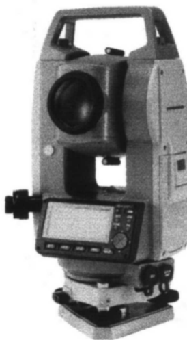
Figura. 3.38 – Estação total electrónica (Sokkia SET500).
